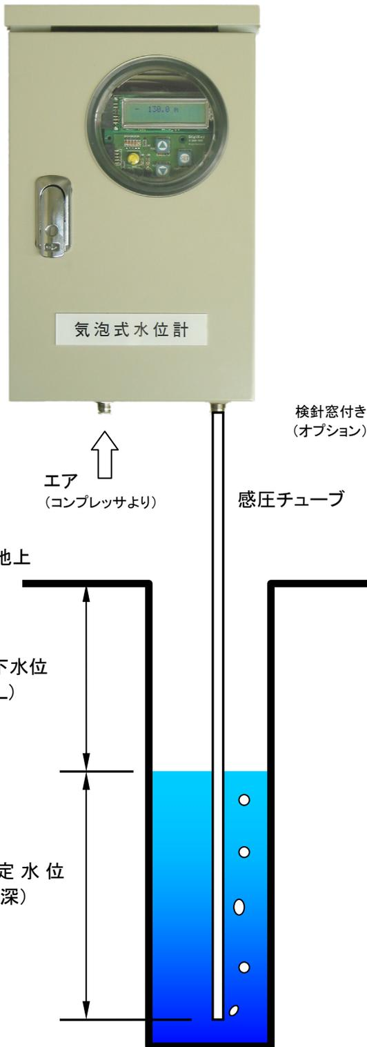
気泡式水位計 UT814A／UT816Aシリーズは、水深10mから500mまで、測定範囲に応じて幅広く対応した水位計です。UT814Aは浅井戸用、UT816Aは深井戸用です。
